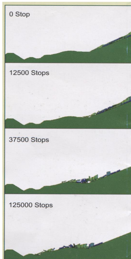
Рисунок 5.8 – Исследование поведения оползневого тела после оползня с помощью моделирования на основе метода Разрывного Деформационного Анализа (Discontinuous Deformation Analysis DDA). (Soil and Water Conservation Bureau, SWCB)
