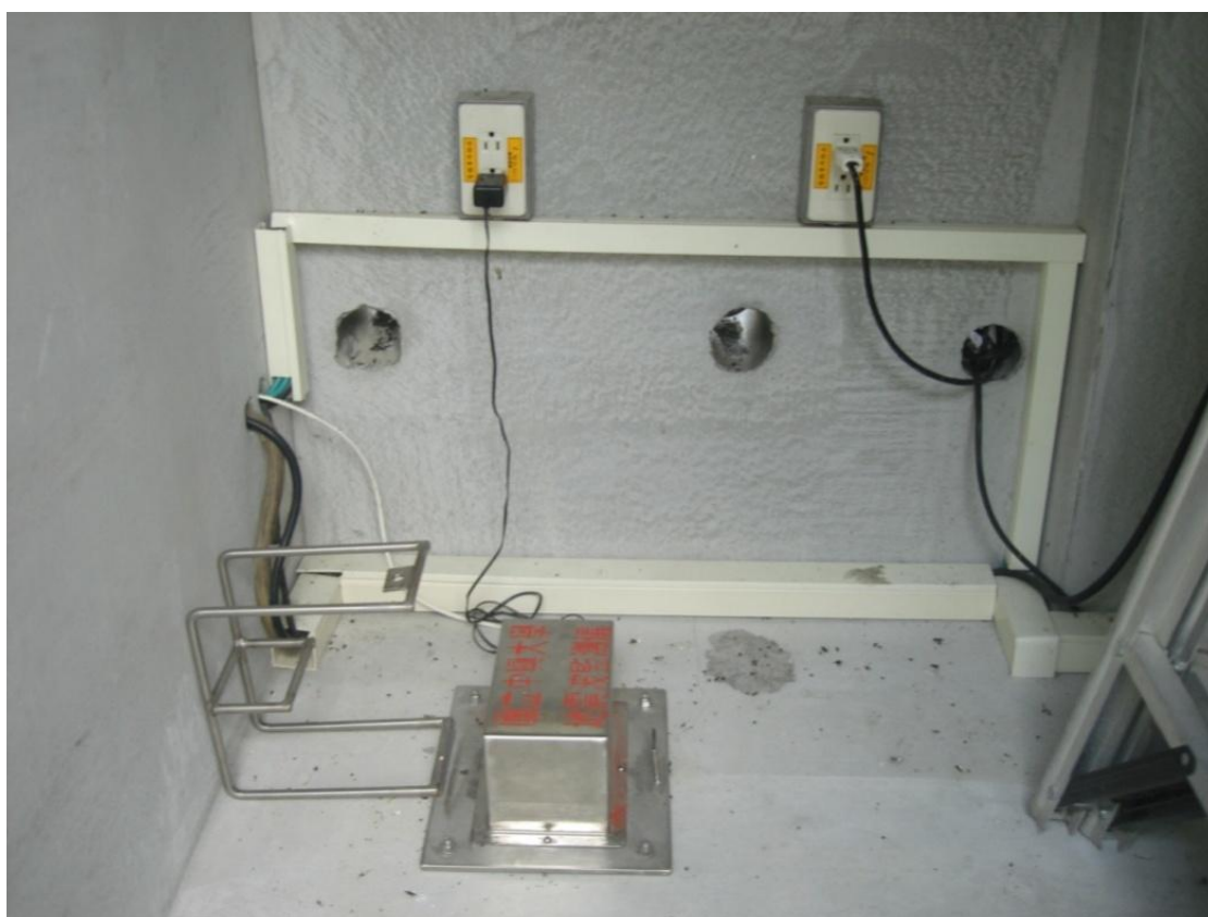
Рисунок 5.24 – Сейсмометр CV-373 (Тайвань-Япония). (Фото Сваловой В.Б.)
